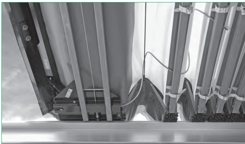
Hinteres Verdeckende mit Edscha TS-Portalbalken, Seilanbindung und Verriegelung
